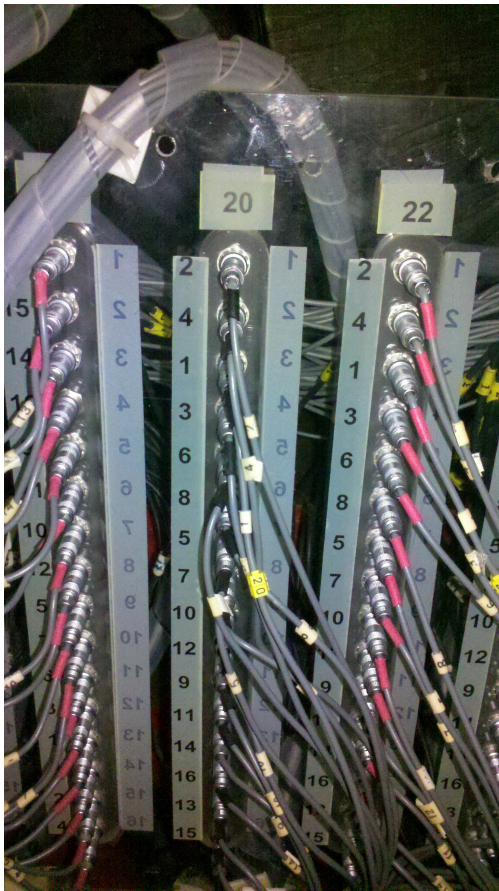
Abbildung 3.28: Bild der Steckerplatten mit den Lemo-Kupplungen. Von vorne werden die Signalkabel der Photomultiplier eingesteckt (Nummerierung richtig herum zu lesen) von hinten die Lemo-Kabel (Nummerierung spiegelverkehrt, weil sie durch die Plexiglasplatte durchscheint), die zu den Diskriminatoren führen.
