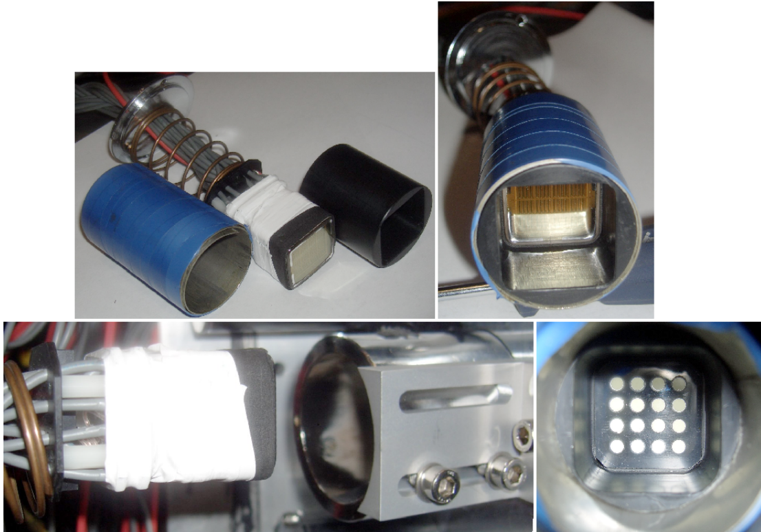
Abbildung 3.22: Halterung der Photomultiplier der horizontalen Lage. Oben links: \mu -Metallrohr mit blauem Tape, Photomultiplier ohne Plastikhülle mit Druckfeder und Deckel und Führung zwischen Photomultiplier und Modulende. Oben rechts: Photomultiplier im \mu -Metallrohr. Unten links: Photomultiplier vor dem runden Eisenrohr. Unten rechts: Blick in des Eisenrohr auf das Ende eines Moduls.
