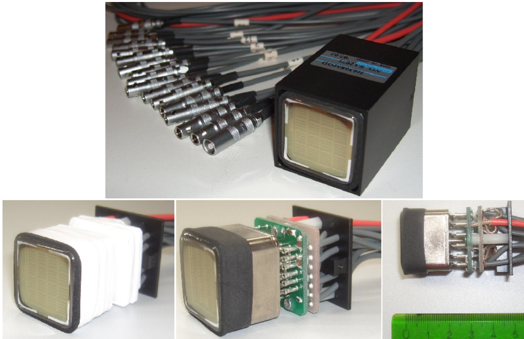
Abbildung 3.8: Der Photomultiplier H6568 von Hamamatsu. Oben: ein Photomultiplier mit 16 grauen Signalkabeln und Lemo-Steckern und einem roten HV-Kabel mit einer Lemo-Buchse. Unten: der Photomultiplier ohne seine schwarze Plastikhülle, welche zur Reduktion von Lichteinstrahlung verwendet wird. Hier kann auch der Spannungsteiler erkannt werden.
