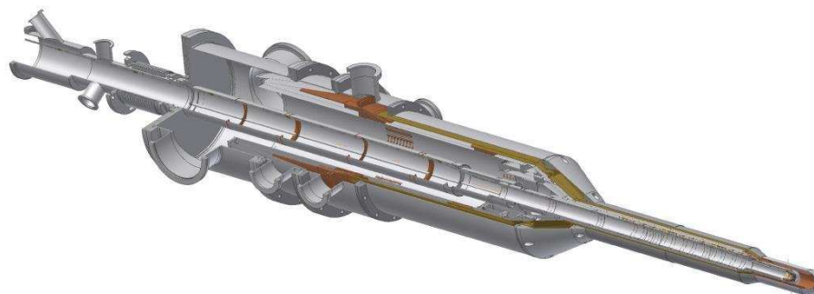
Abbildung 3.11.: Der Kryostat des polarisierten Targets mit integriertem Targethalter. Im rechten Bereich befindet sich die Targetzelle mit den polarisierbaren Nukleonen.
