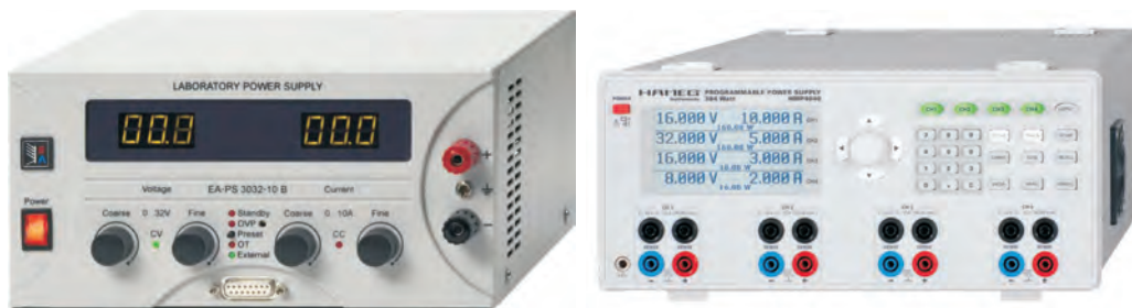
Abbildung 4.9: Für die Versorgung der Ausleseelektronik verwendete Labornetzgeräte: EA-PS 3016-20B (links) und HAMEG 4040 (rechts).
