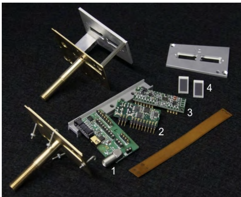
Abbildung 1.20: Neue entwickelte und im Gehäuse der Kristalle untergebrachte Elektronik (1-3) und Avalanche-Photodioden (4).
