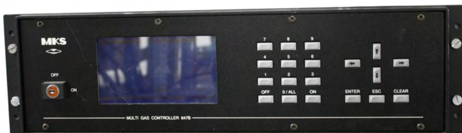
Abbildung 4.13: MKS 647b Gasfluss-/Druck-Controller zur Steuerung und Auslese der Gasflussregler.
