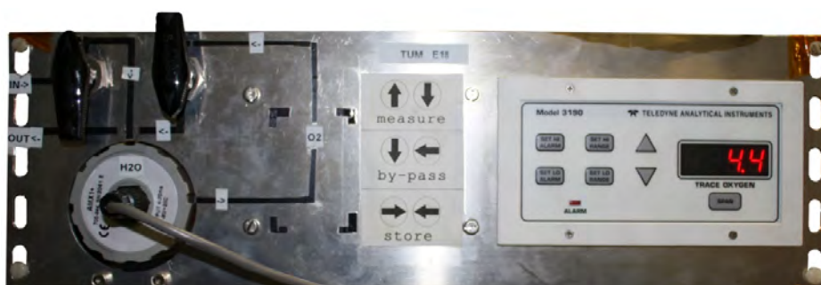
Abbildung 4.14: Gasmesssystem für die Test-TPC mit Feuchtigkeitssensor (links) und Sauerstoffsensor (rechts).
