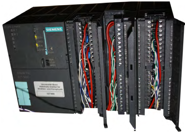
Abbildung 4.10: Geöffnete SPS mit Zentralbaugruppe, Eingabebaugruppe zur Strom- und Spannungsmessung, Ausgabebaugruppe und Eingabebaugruppe zur Temperatur- oder Widerstandsmessung (von links nach rechts).
