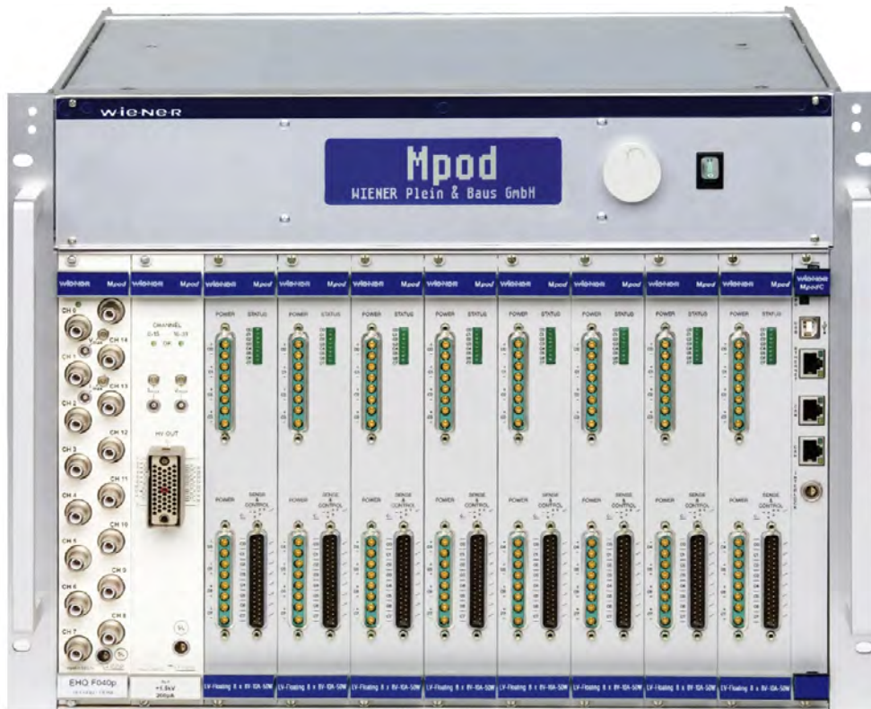
Abbildung 4.1: W-IE-NE-R MPOD-Crate mit ISEG Hochspannungsmodulen [103].
